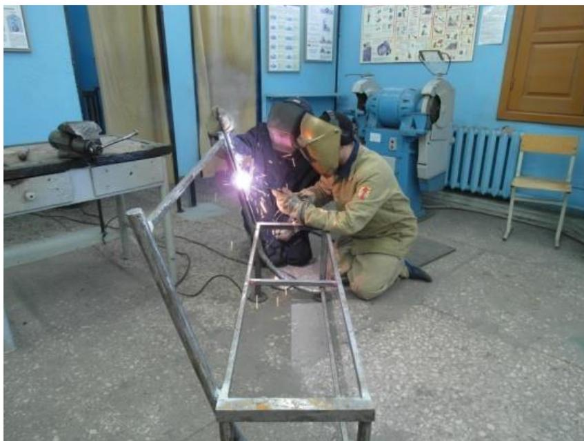
Газосварщик, кроме сварки, выполняет работы по резке деталей различной длины и по различным контурам, осуществляет наплавку, пайку и подогрев металла. Труд электрогазосварщика в основном ручной, выполняется индивидуально, при минимальном деловом общении.
