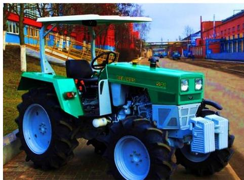
Сейчас МТЗ активно продвигает на рынке новую модель трактора — **BELARUS-541**, который способен выполнять как транспортные работы, так и работать на рисовых полях.
